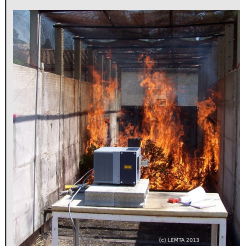
Essai en tunnel à feux au CEREN à Valabre
